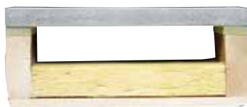
Plancher béton sur ossature bois
