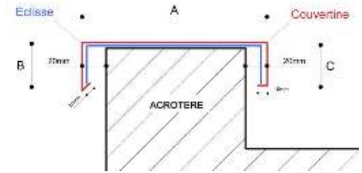
NOTA : Pour un montage plus facile avec éclisse, le pli de la couvertine côté toiture est à 90°
