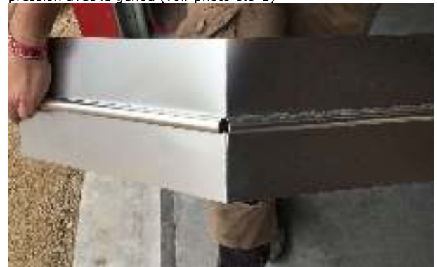
Photo 6.9-1: Casse de la tôle au point de pré découpe
