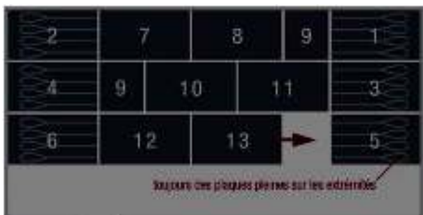
Figure 6.7.2 : Progrès de la pose de plaques isolantes rainurées
