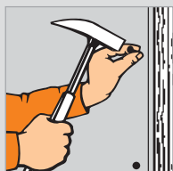
Figure 9 : Clouage sur ossature bois
