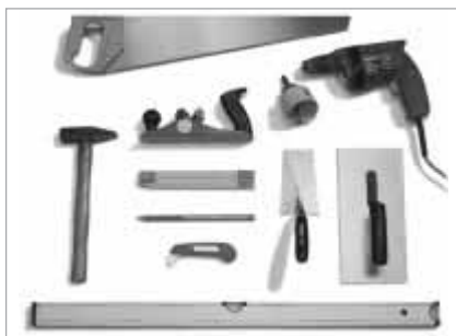
Figure 2 : Outillage de façonnage traditionnel en construction sèche
