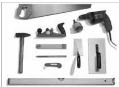
Figure 2 : Outillage de façonnage traditionnel en construction sèche
