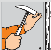
Figure 9 : Clouage sur ossature bois
