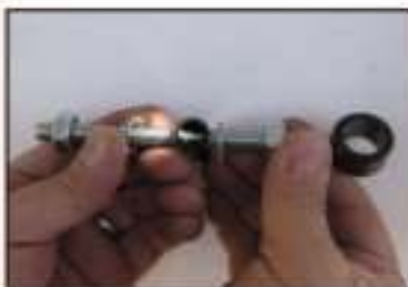
14. Dévisser les écrous et la tige filetée de la pièce de raccordement pour avoir du jeu.
