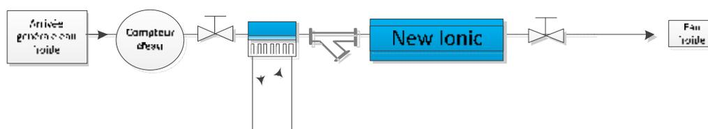
*Schéma d'installation sur l'arrivée générale*
