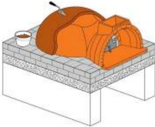
Après le mouillage des joints entre les différents éléments qui composent le dôme, enduire le dôme avec 5 cm de REFRA-X à l'extérieur. Si vous voulez avoir une plus grande inertie thermique, il est recommandé de jeter une couche de REFRA-X partout sur le dôme d'une épaisseur allant jusqu'à 6 cm. Dans les grands fours, une fine toile métallique doit être ajoutée à REFRA-X.
