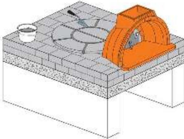
Mouiller les interstices entre les pièces qui composent la sole et de les remplir avec REFRAUX, en prenant soin de garder le remplissage légèrement inférieur au plancher. L'espace entre la sole et les murs de la coupole doit être laissé au repos et ne doit pas être plâtré.
