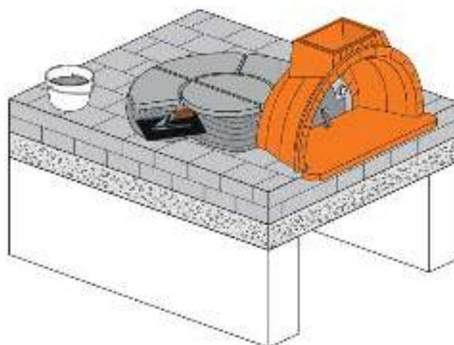
Après avoir mouillé le sol, étaler une fine couche de REFRAUX avec une spatule dentée et fixer les pièces composant le sol.
