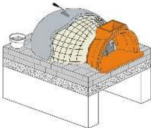
Si vous voulez maintenir la forme sphérique de la vue ouverte du four, vous pouvez faire une coulée de sable et de ciment de 3/4 cm au-dessus de l'isolation extérieure, sur laquelle une couche de treillis métallique a été positionnée précédemment.
