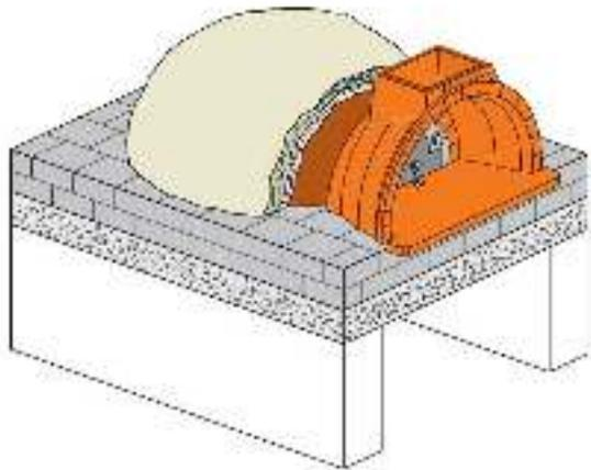
Après la couche de REFRA-X, isoler thermiquement le four en plaçant plusieurs couches de fibres céramiques sur le dôme. Nous recommandons une première couche de fibre céramique de 2/4 cm suivie d'une couche de 10/15 cm de vermiculite, argile expansé ou de la laine de roche pour les hautes températures.
