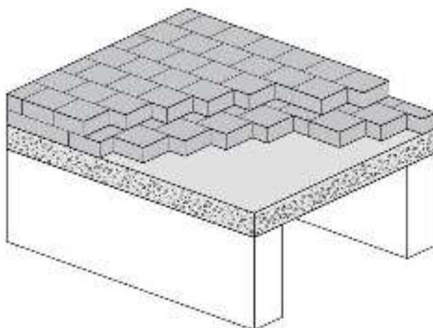
Créer un plancher d'environ 15 cm de haut avec des panneaux en béton cellulaire léger ou en béton allégé avec de l'argile ou de la vermiculite expansée.
