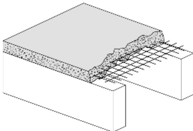
Créer deux supports en maçonnerie d'environ 75 cm de haut pour obtenir un plancher de feu environ 110 cm de hauteur. Placez une dalle de béton de charge environ 15 cm d'épaisseur.
