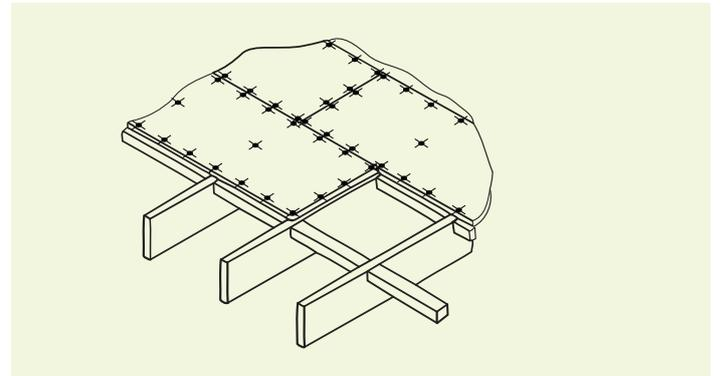
Pour atteindre les valeurs en charge des tableaux ci-dessous, les morceaux de panneaux sciés doivent toujours être supportés par minimum 3 poutres.
