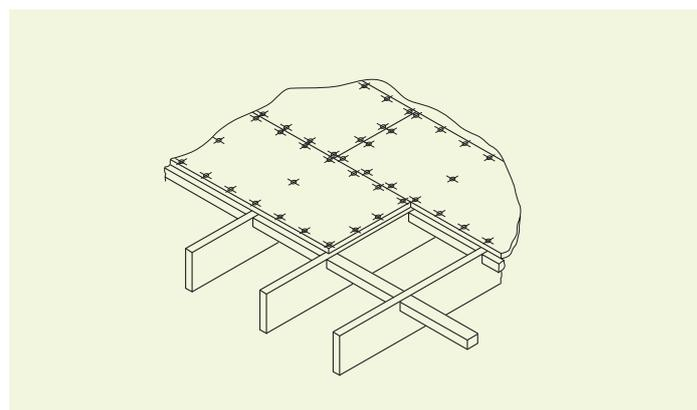
Pour atteindre les valeurs en charge des tableaux ci-dessous, les morceaux de panneaux sciés doivent toujours être supportés par minimum 3 poutres.
