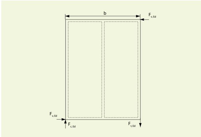
Les forces extérieures  $F_{c,Ed}$  en  $F_{t,Ed}$  peuvent être transmises aux panneaux de la paroi voisine ou à la construction sous-jacente ou supérieure. Si les forces de traction sont transmises à la construction sous-jacente, le panneau doit être ancré avec des éléments d'assemblage rigides. Le flambage des barres murales doit avoir été contrôlé (pour la méthode, voir Eurocode 5).
