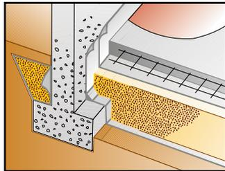
Extrêmement stable et durable, elle garantit un support fiable à la dalle de base du bâtiment ou à ses fondations. Elle peut être également utilisée pour l'isolation, le drainage et la réduction des poussées de murs enterrés, même à l'aide de modules spéciaux TermoBag qui permettent la pose en épaisseur contrôlée.
