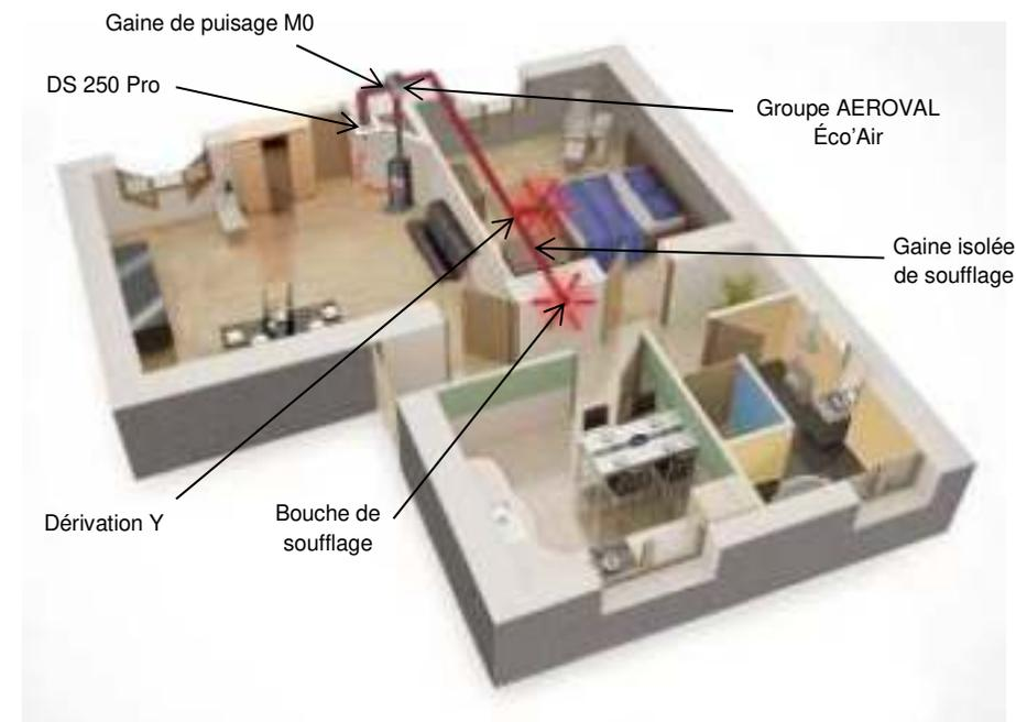
Exemple de montage 2 bouches (Schéma de montage)
